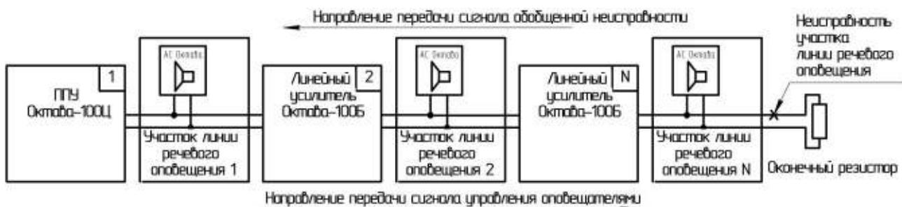
Рисунок 1.3 - Схема передачи сигнала «Неисправность»
