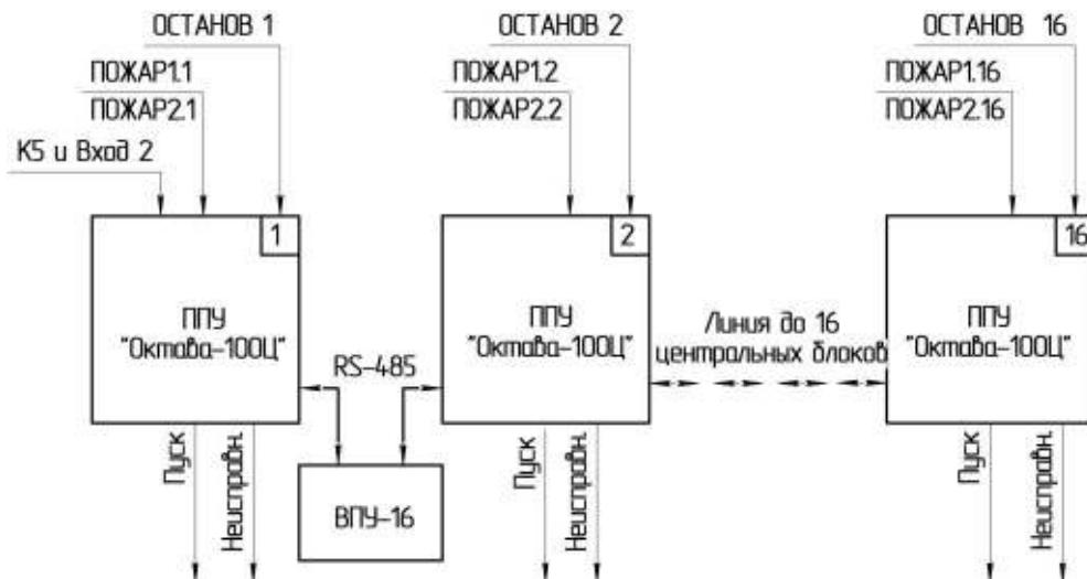
**П р и м е ч а н и е -** Схема подключения приведена для общего случая. В частном случае любой из сигналов ППКП на входе ППУ может отсутствовать
