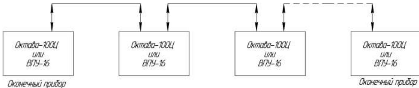
Рисунок 3.1 - Схема подключения ТС к линии RS-485
