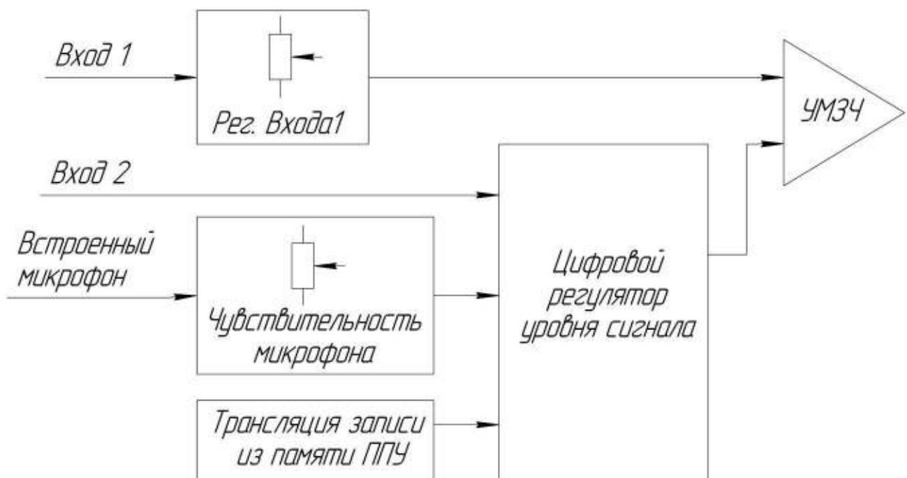
Рисунок Д.1 - Структурная схема звукового тракта ППУ «Октява-100Ц»
