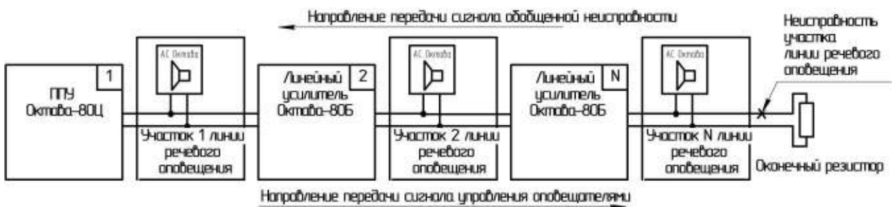
Рисунок 1.2 - Схема передачи сигнала «Неисправность» по линии речевого оповещения
