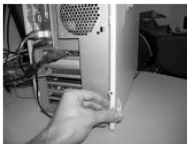
Рис. 3.1-1. Демонтаж крышки корпуса системного блока
