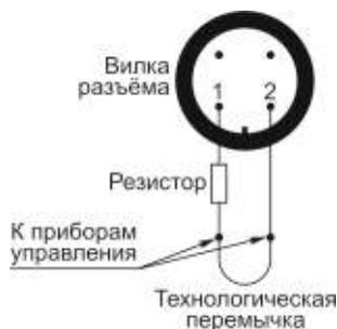
Рис. 5. Схема подключения МПП к линии пуска
