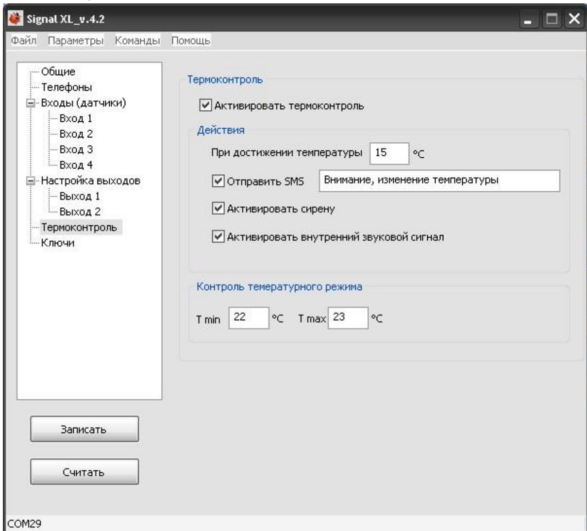
Для того что бы включить данную опцию, установим флаг в окне «**Активировать термоконтроль**». В случае если нужно оповещение при достижении заданного значения температуры, в окне «**При достижении температуры**», установим нужное значение в °C, (допускается устанавливать значение от 01 до 99).
