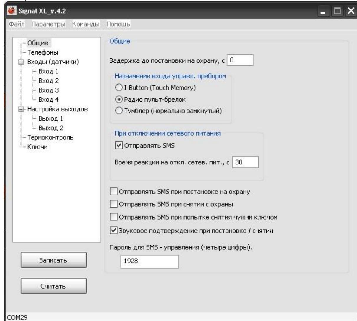
На странице «**Общие**» задаются параметры всей системы: **«Задержка до постановки на охрану»** это время, по истечении которого система встанет на охрану, нужно для того, чтобы покинуть помещение не вызвав тревогу, если считыватель или кнопка / тумблер установлен внутри помещения. Допускается устанавливать значение в диапазоне 0...255 с.
