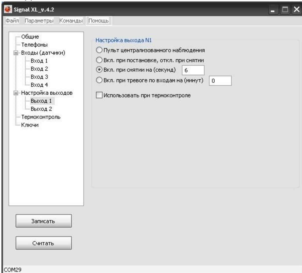
На странице **«Настройка выходов»** задаются алгоритмы работы выходов 1 (рейный) и 2 (ключ, с возможностью подключить реле), каждому выходу можно задать один из четырех режимов работы.
