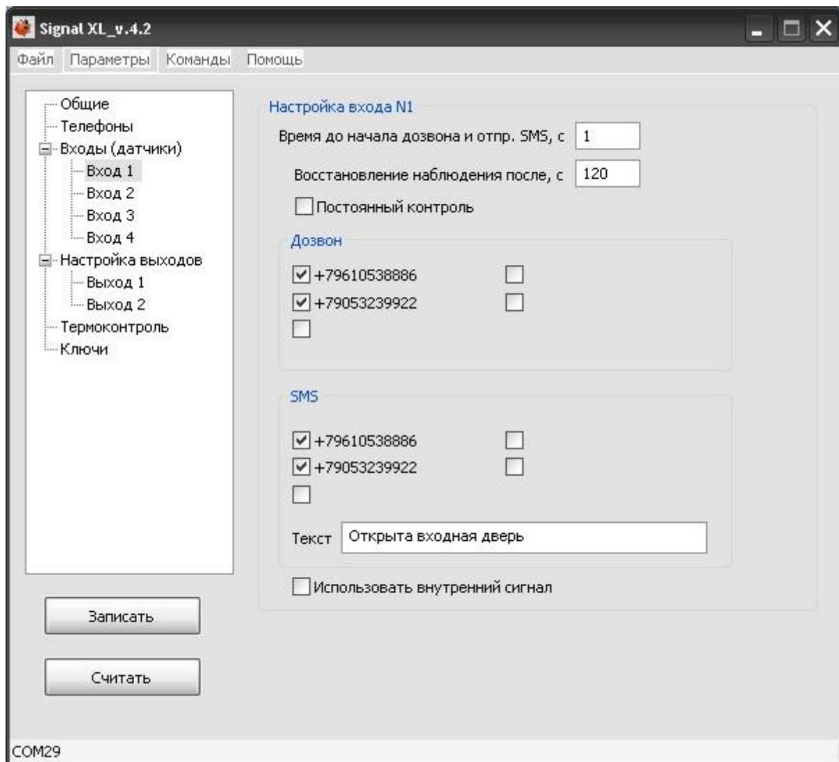
На странице «**Входы**» устанавливаются параметры для каждого входа (шлейфа) отдельно. В окне «**Время до начала звона и отправки SMS**» устанавливаем
