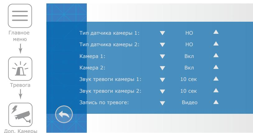
Программный детектор движения позволяет обнаруживать движение объектов без использования внешних датчиков, путем регистрации изменений, происходящих в области обзора используемой видеокамеры. Для реализации данной функции, питание камеры, используемой для детекции движения, должно быть постоянно включено. Это нужно для того, чтобы домофон имел доступ к изображению, поступающему с камеры и мог регистрировать его изменение.
