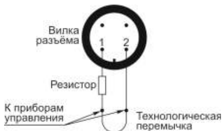
Рис. 5. Схема подключения МПП к линии пуска
